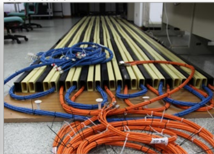
Test de diaphonie exogène de canal cat. 6A
